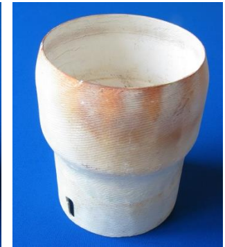
Flammrohr Keramikblech nach 20.000 h im Einsatz
