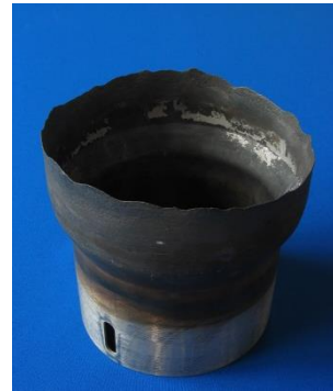
Flammrohr Metall aus 1.4541 nach 1000 h
